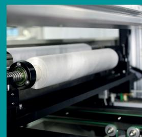
Zur Reinigung der Schablonen stehen unterschiedliche Kombinationen aus Nass- /Trocken- und Vakuumreinigung zur Verfügung.
