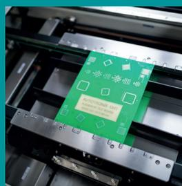
Leitet Einrichten von ein- bzw. doppelseitigen Leiterplatten. Anschläge gewährleisten eine immer wieder gleiche Positionierung.
