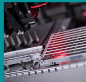
Komponenten auf Gurten, Stangen, Abschnitten, lose Bauteile und Trays können verarbeitet werden.
