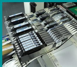
CANBUS verbindet alle Module die in der Feeder-Steuerung arbeiten, sodass diese umso effektiver, intelligenter und mit weniger Kabeln kommunizieren.
