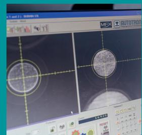
Ausrichtung der Leiterplatte zur Schablone mittels automatischer Referenzpunkterkennung
