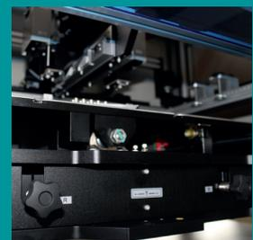
Ausrichtung der Leiterplatte zur Schablone mittels Justierschrauben auf den X/Y/R Achsen
